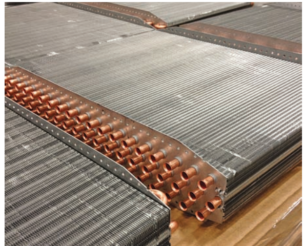
Ilustração 4 - Tubos de cobre ajudam a reduzir o tamanho dos sistemas de ar-condicionado (AirTek Aquecimento e Ar-condicionado, Chicago, USA)
