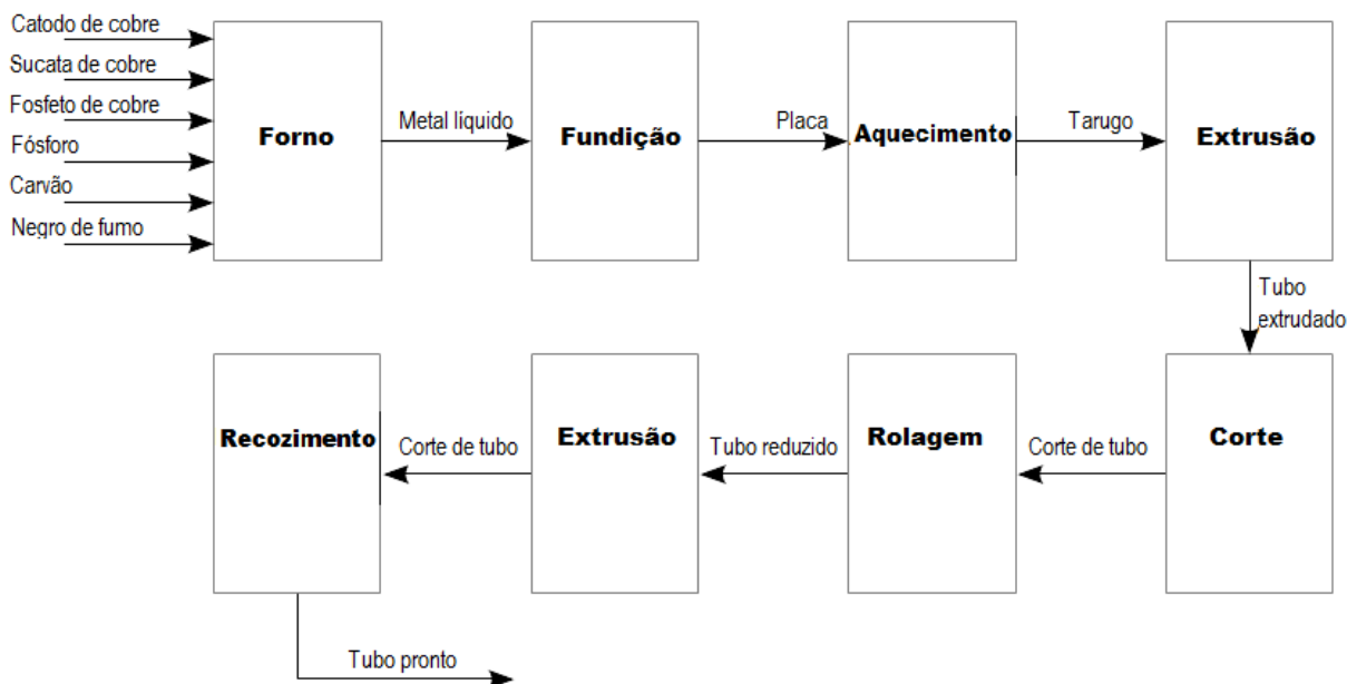
Figura 1: Fluxograma que descreve o processo de fabricação de tubos de cobre
